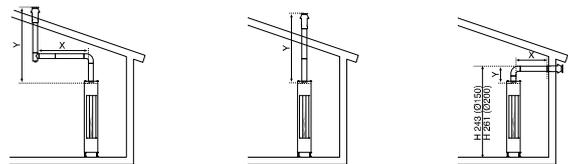
Y - con tramo vertical inferior de 50 cm, póngase en contacto con el Departamento Técnico para comprobar la factibilidad en función del recorrido de las tuberías.
